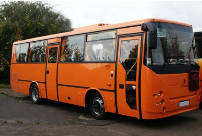
A0909L.05.01 w wersji szkolnej z dodatkowym wyposażeniem: klimatyzator, retarder elektromagnetyczny.
