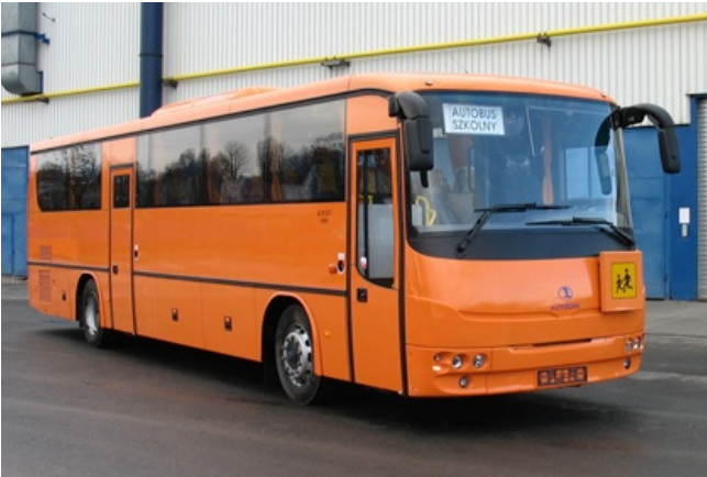
A1012T Lider w wersji szkolnej z silnikiem Cummins ISBe 4 300 EURO 4 + skrzynią mechaniczną ZF 6S-1200.
