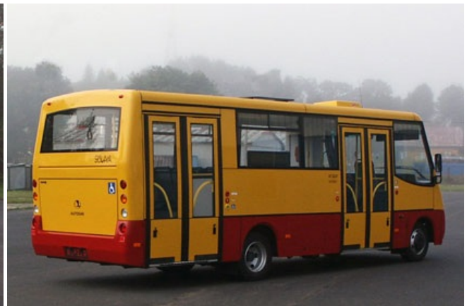
Autobus H7-20.07 na podwoziu Vario 818D, silnik OM904LA EURO 4 o mocy 130kW przy 2200 obr/min, automatyczna skrzynia biegów Allison LCT 1000, retarder elektromagnetyczny CC80.
