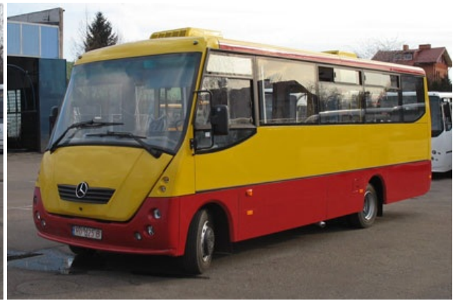
A0909L.05.01 w wersji szkolnej z dodatkowym wyposażeniem: klimatyzator, retarder elektromagnetyczny.
