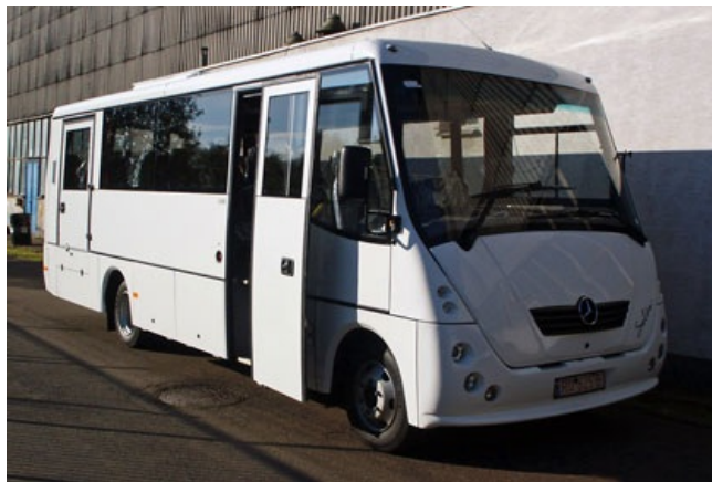
Autobus H7-20.07 na podwoziu Vario 818D, silnik OM904LA EURO 4 o mocy 130kW przy 2200 obr/min, automatyczna skrzynia biegów Allison LCT 1000, retarder elektromagnetyczny CC80.
