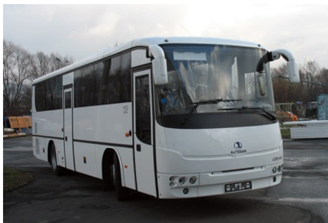
Autobus A1010T dla MON z silnikiem Cummins ISBe 4 300 EURO 4 i skrzynią mechaniczną ZF 6S-1200.
