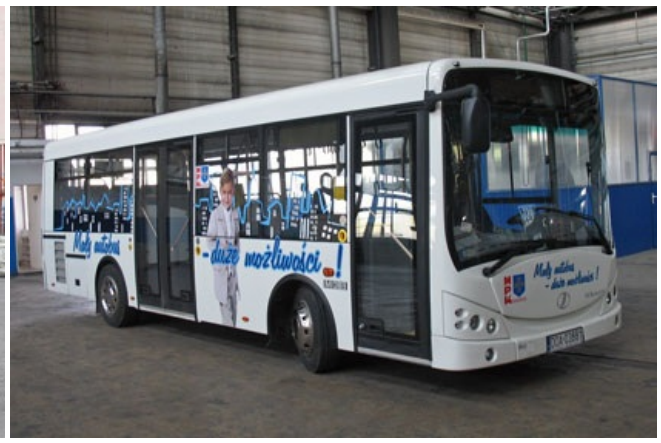
Autobus H7-10.07 na podwoziu Vario 818D, silnik OM904LA EURO 4 o mocy 130kW przy 2200 obr/min, automatyczna skrzynia biegów Allison LCT 1000, retarder elektromagnetyczny CC80. Autobus przeznaczony na rynek skandynawski.
