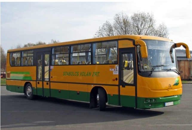
Seria 10 sztuk autobusu A1012T z silnikiem Renault Dxi7 235 EURO 4 i skrzynią biegów mechaniczną ZF 6S-1200, przeznaczonych dla węgierskiego przewoźnika Volan.
