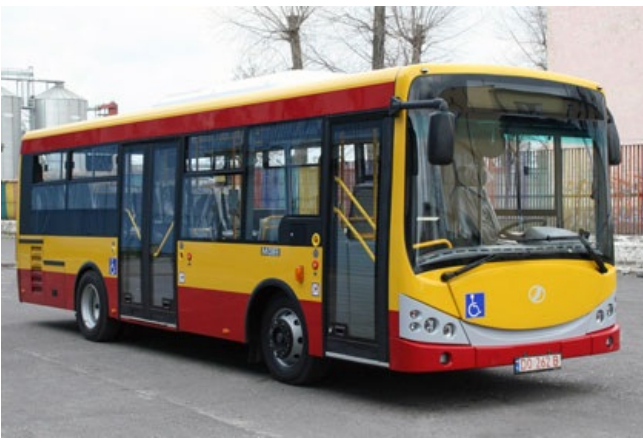
Autobus H7-10.07 na podwoziu Vario 818D, silnik OM904LA EURO 4 o mocy 130kW przy 2200 obr/min, automatyczna skrzynia biegów Allison LCT 1000, retarder elektromagnetyczny CC80. Autobus przeznaczony na rynek skandynawski.
