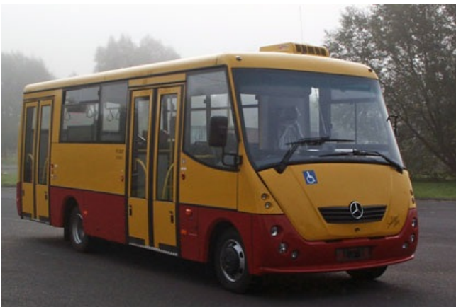
Autobus A0909L.05.01- silnik Cummins ISBe4 185 EURO 4 w wersji z klimatyzatorem.
