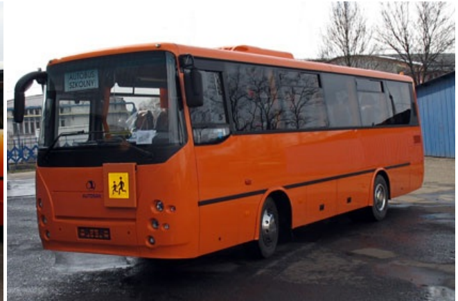
A0909L.05.01 w wersji szkolnej z dodatkowym wyposażeniem: klimatyzator, retarder elektromagnetyczny.
