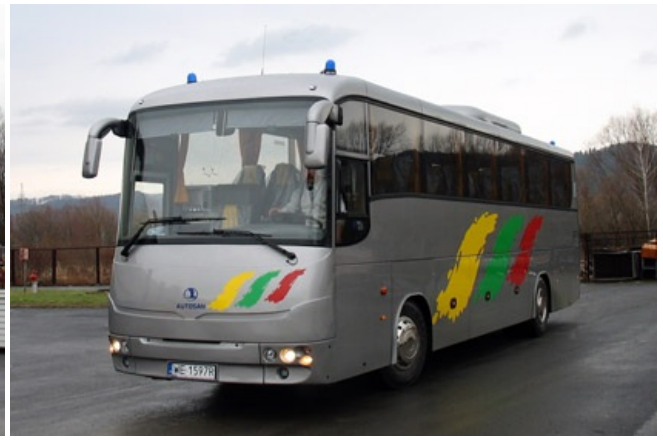
A1012T Lider w wersji szkolnej z silnikiem Cummins ISBe 4 300 EURO 4 + skrzynią mechaniczną ZF 6S-1200.
