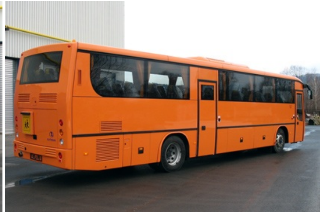
A1012T Lider w wersji szkolnej z silnikiem Cummins ISBe 4 300 EURO 4 + skrzynią mechaniczną ZF 6S-1200.
