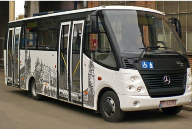
Autobus międzymiastowy wykonany na pojeździe bazowym Sprinter 518CDI firmy MB. Silnik o mocy 135 kW przy 3800 obr.min, skrzynia sześciobiegowa sterowana mechanicznie, liczba miejsc siedzących 18.
