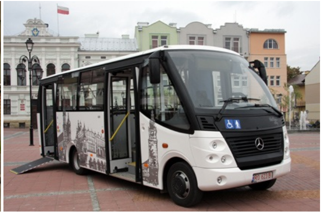
Autobus międzymiastowy wykonany na pojeździe bazowym Sprinter 518CDI firmy MB. Silnik o mocy 135 kW przy 3800 obr.min, skrzynia sześciobiegowa sterowana mechanicznie, liczba miejsc siedzących 18.
