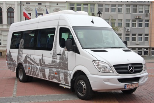
Autobus międzymiastowy wykonany na pojeździe bazowym Sprinter 518CDI firmy MB. Silnik o mocy 135 kW przy 3800 obr.min, skrzynia sześciobiegowa sterowana mechanicznie, liczba miejsc siedzących 18.
