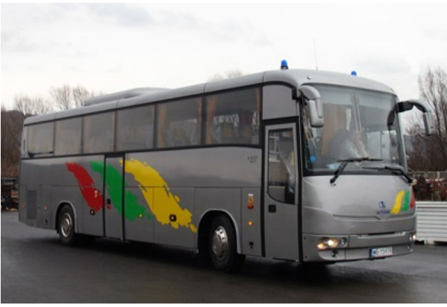
A1012T Lider w wersji szkolnej z silnikiem Cummins ISBe 4 300 EURO 4 + skrzynią mechaniczną ZF 6S-1200.
