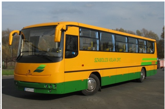
Seria 10 sztuk autobusu A1012T z silnikiem Renault Dxi7 235 EURO 4 i skrzynią biegów mechaniczną ZF 6S-1200, przeznaczonych dla węgierskiego przewoźnika Volan.
