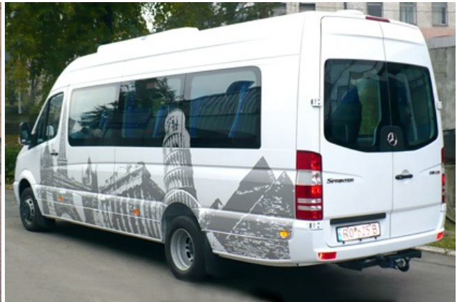
Autobus międzymiastowy wykonany na pojeździe bazowym Sprinter 518CDI firmy MB. Silnik o mocy 135 kW przy 3800 obr.min, skrzynia sześciobiegowa sterowana mechanicznie, liczba miejsc siedzących 18.
