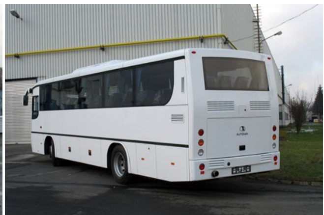
Autobus A1010T dla MON z silnikiem Cummins ISBe 4 300 EURO 4 i skrzynią mechaniczną ZF 6S-1200.
