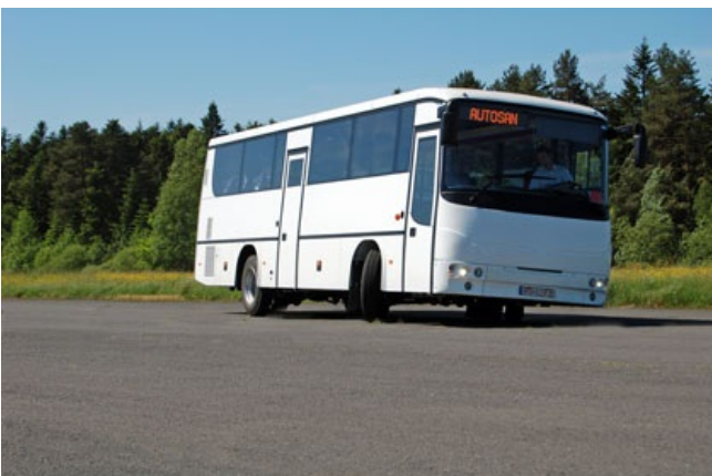
Autobus A1010T z silnikiem Cummins ISBe 4 300 Euro4 z instalacją elektryczną opartą w całości na magistrali typu CAN. Hamulce uruchamiane są przez elektroniczny układ EBS firmy Wabco łączący właściwości działania dotychczas stosowanych układów ABS i ASR. W autobusie zamontowano również układ elektronicznej stabilizacji toru jazdy ESC (ESP). Dokonano również zmiany w zawieszeniu przednim - zastosowano zawieszenie niezależne. Na zdjęciach autobus podczas testów ESC.
