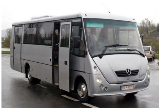
Autobus H7-10.07 na podwoziu Vario 818D, silnik OM904LA EURO 4 o mocy 130kW przy 2200 obr/min, automatyczna skrzynia biegów Allison LCT 1000, retarder elektromagnetyczny CC80. Autobus przeznaczony na rynek skandynawski.
