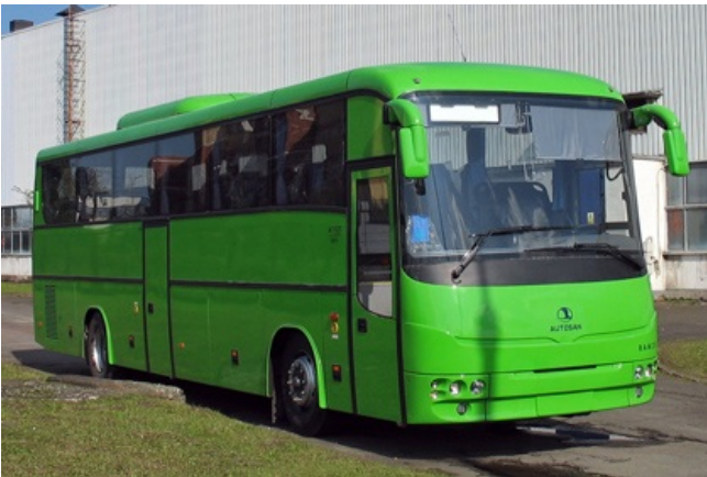
Seria 10 sztuk autobusu A1012T z silnikiem Renault Dxi7 235 EURO 4 i skrzynią biegów mechaniczną ZF 6S-1200, przeznaczonych dla węgierskiego przewoźnika Volan.
