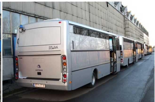
Autobus A1012T.08.20 Ramzes dla CZSW, silnik Cummins ISLe4 320 EURO 4 zblokowy ze skrzynią automatyczną Allison T350R. Instalacja elektryczna w całości oparta na magistrali CAN. Autobus wyposażony w układy EBS i ESC Wabco.
